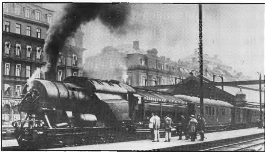
Första provloket litt. A, försett med sadeltank. På bilden klart för avgång från Stockholm Central.
