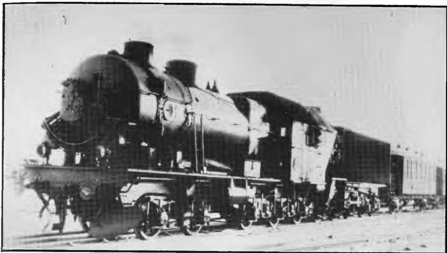
SJ litt. Å nr 1474. I sitt slutliga utförande slopades sadeltanken och vattenförrådet flyttades till kondensornavn. Loket byggt av NOHAB 1927 och slopat 1932.
